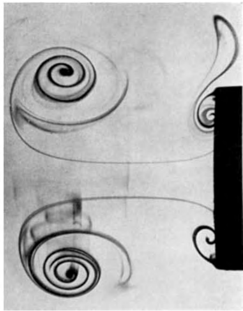
Abb. 5. Die Entstehung eines Wirbelrings im Schnitt, etwas später aufgenommen
